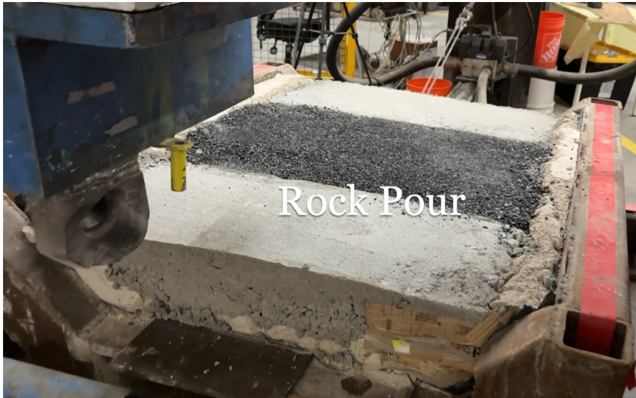
Figure 29 Rock Pour for variable strength Rock Simulant.
